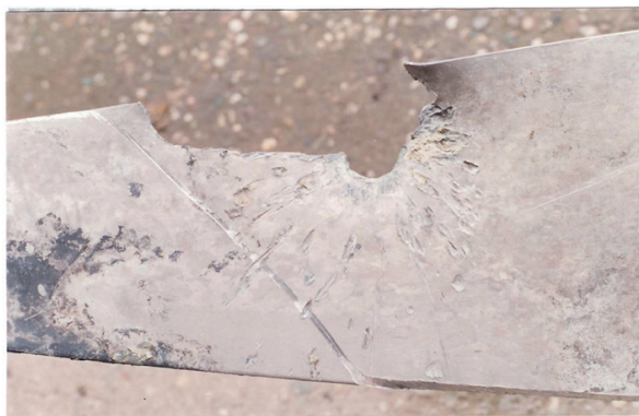
Een detailopname van de propeller van van Roos' toestel; Inslag van een 20 mm granaat
